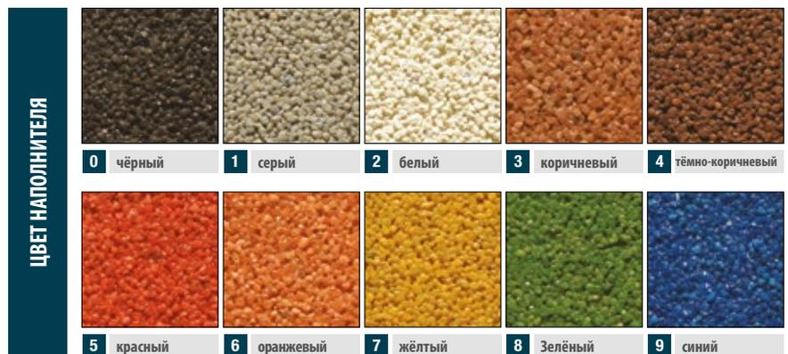
Одна буква символа означает 25% доли определенного наполнителя в смеси. Это соответствует 2,925 кг наполнителя для ведра ёмкостью 16 кг, содержащего 4,3 кг премикса. Расход: 3,1-3,5 кг/м<sup>2</sup>.
